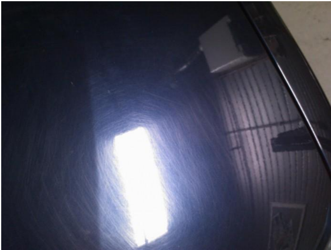
Wasstraat schade aan de motorkap
